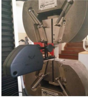
Figura 3.3 – Ensaio de tração uniaxial
