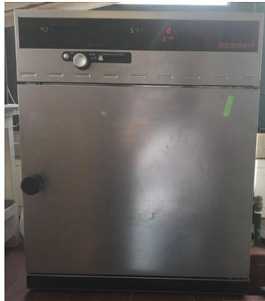
Figura 19 –Estufa utilizada no tratamento térmico das amostras (Mettler GmbH +Co. KG).
