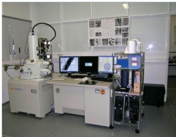
Figura 20 - Microscópio eletrónico de varrimento (FEG-SEM, JEOL JSM-70001F).
