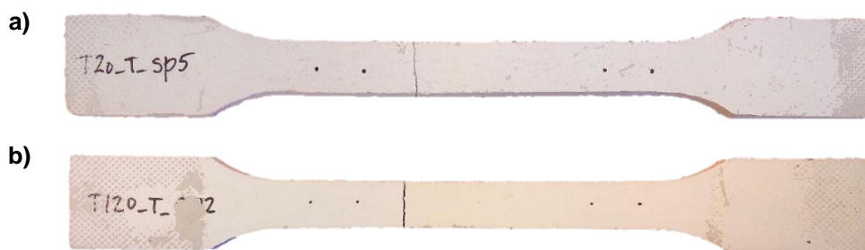
Figura 56 – Modo de rotura mais comum verificado nos ensaios de tração a a) 20 °C e a b) 120 °C.
