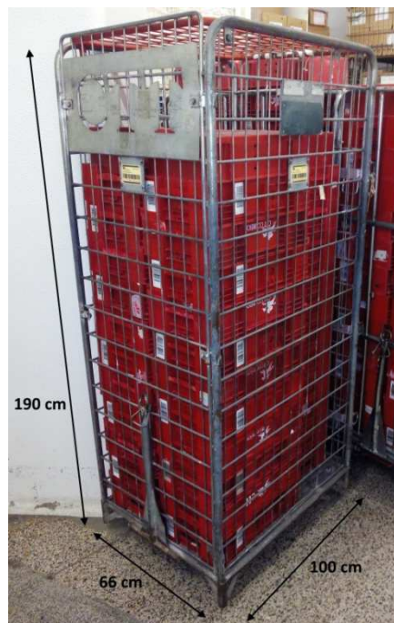
Figura 8 – Gaiola rolante metálica
