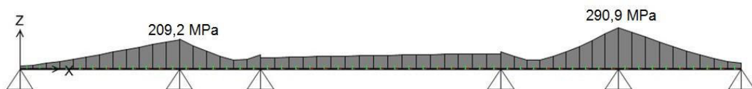
Figura 3.31 – Estado de tensão máxima para o perfil HEB550
