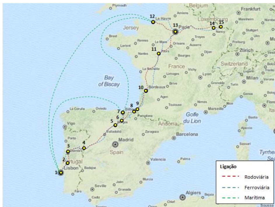
Figura 12 – Esquematisação da cadeia de transporte simplificada, baseada no Corredor Atlântico
