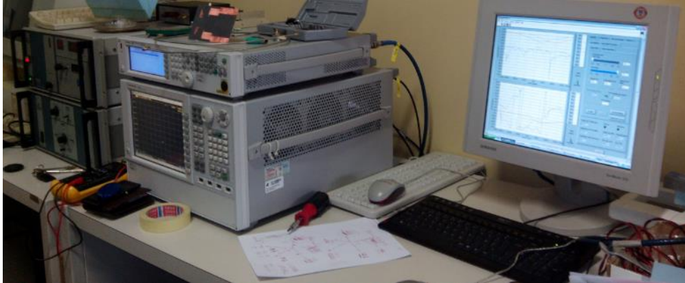
Figura 47 - Gerador de sinal e recetor de sinal (exterior da câmara anecóica)
