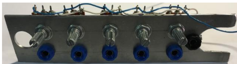
Figura 42 - Dispositivo de controlo das tensões aplicadas aos monopolos parasitas
