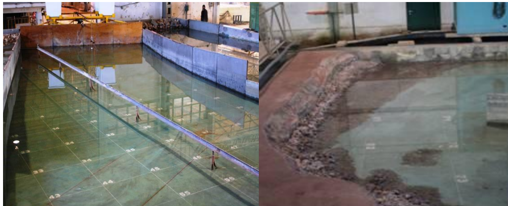
Figura 3.3 -Tanque de ondas irregulares, a) Aspetto geral; b) Batimetria, retirado de Fortes et al. (2008)
