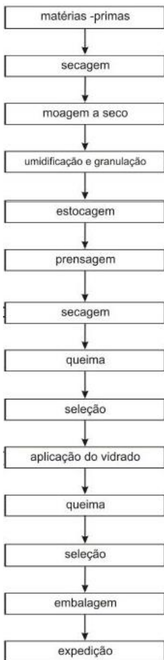
Figura 22. Diagrama de processo de conformação por via seca de revestimentos cerâmicos [52]
