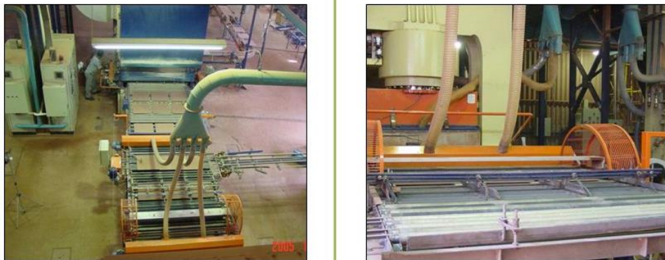
Figura 21. Processo de fabrico de conformação por via húmida (à esquerda), e por via seca (à direita) [32]
