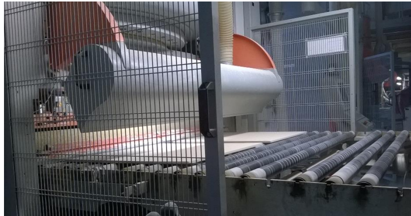
Figura 19. Processo de conformação por prensagem a seco
