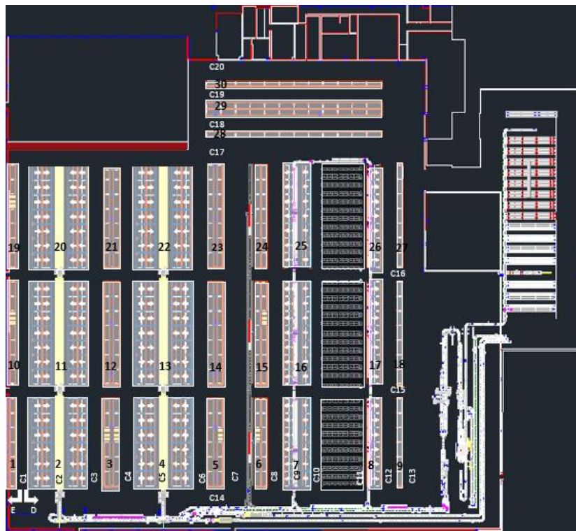
Figura 31 - Divisão do layout proposto pela Empresa X para o novo armazém em blocos
