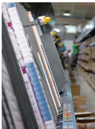
Figura 7 - Equipamento que efetua a operação de picking de forma automática
