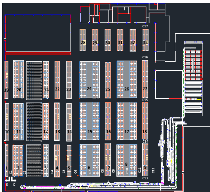
Figura 32 - Proposta de layout 1: Distribuição em corredores paralelos na vertical
