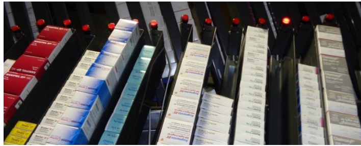
Figura 29 - Sistema Kanban eletrônico nos canais do automático
