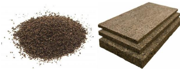
Figura 2.1 - Granulado de cortiça expandida (à esq.); aglomerado de cortiça (à dta.) (W1, 2015)
