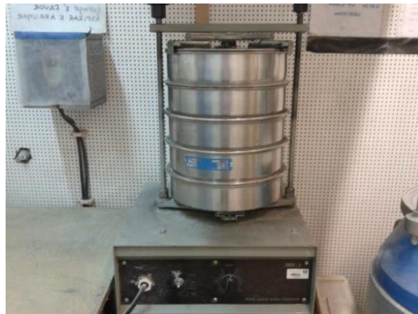
Figura 3.3 – Peneiração dos agregados
