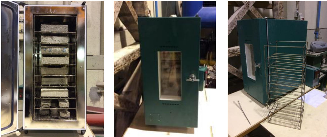
Figura 3.10 - Equipamento Tinius Olsen Environmental Chamber antes e durante o ensaio (à esq. e ao centro); estrutura metálica construída para suporte dos provetes durante exposição a temperaturas elevadas (à dta.)
