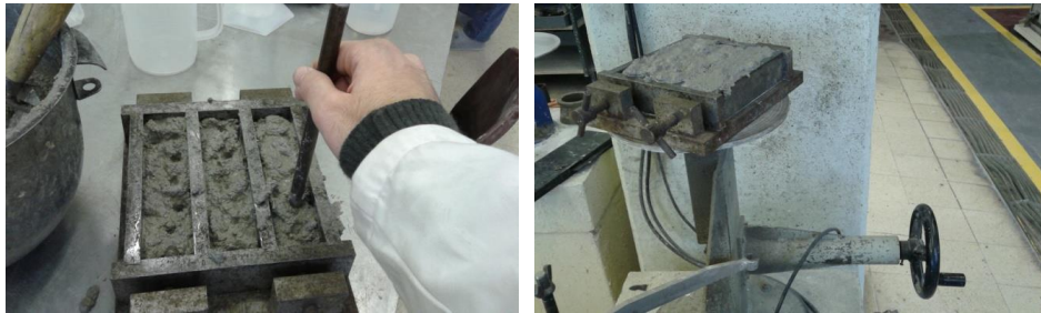
Figura 3.7 – Esquema dos provetes prismáticos (à esq.); compactação das argamassas com pilão metálico (ao centro); compactação mecânica das argamassas (à dta.)
