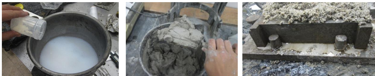
Figura 3.5 – Adição de introdutores de ar à argamassa de aerogel (à esq.); amassadura da argamassa de aerogel (ao centro); segregação visível da argamassa com 10% de resina na fase de moldagem dos provetes (à dta.)
