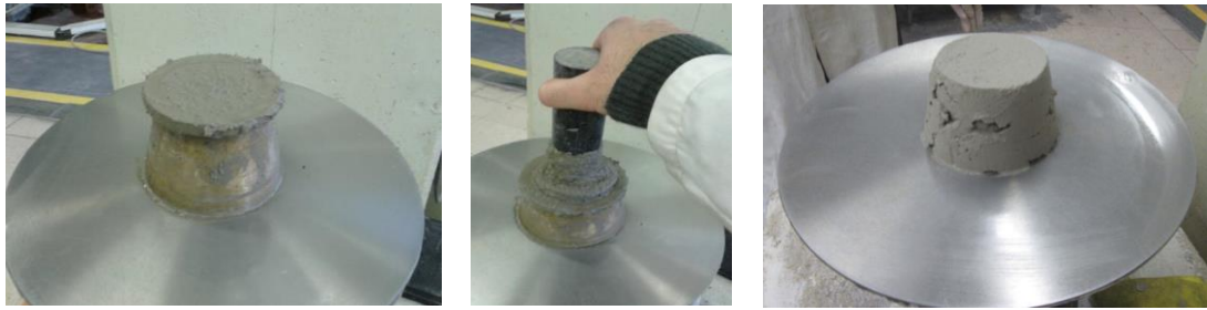
Figura 3.8 – Colocação da argamassa no molde troncocónico (à esq.); compactação da argamassa com o pilão (ao centro); aplicação de 15 pancadas na mesa de espalhamento (à dta.)
