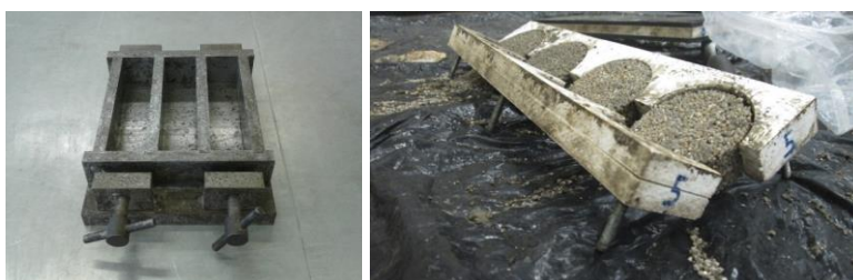
Figura 3.1 - Molde de 3 provetes prismáticos de 160x40x40mm (à esq.); molde com 4 provetes cilíndricos de diâmetro 60 mm e espessura 20 mm (à dta.)
