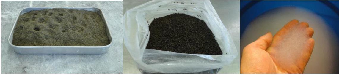
Figura 3.2 – Argila expandida (à esq.); granulado de cortiça expandida (ao centro); aerogel (à dta.)
