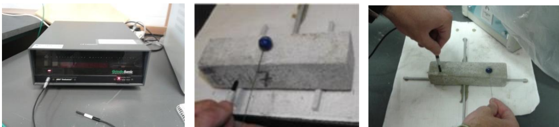
Figura 3.13 – Equipamento GrindoSonic MK5 (à esq.); ensaio para a obtenção da frequência de vibração à flexão (ao centro); ensaio para a obtenção da frequência de vibração à torção (à dta.)
