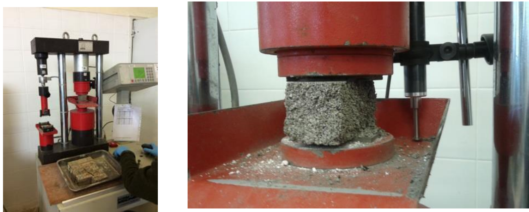
Figura 3.15 - Ensaio de resistência à compressão
