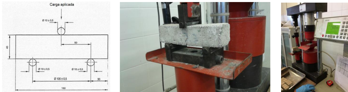
Figura 3.14 - Esquema do ensaio à tração por flexão (EN 1015-11 (CEN, 1999)) (à esq.); ensaio de resistência à flexão por tracção (ao centro e à dta.)
