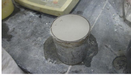
Figura 3.9 – Enchimento de recipiente com a argamassa para determinação da massa volúmica
