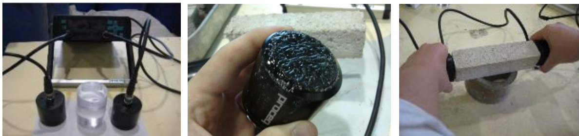
Figura 3.12 – Equipamento Pundit Lab+ (à esq.); aplicação de material de contacto nos transdutores (ao centro); medição do tempo de propagação das ondas ultra-sónicas (à dta.)
