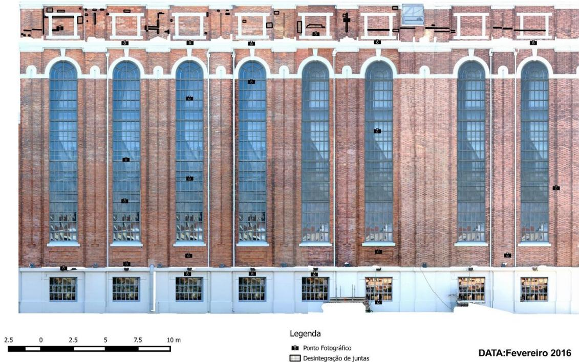
Figura 23 - Distribuição da desintegração das juntas de argamassa detetadas no Edifício de Alta Pressão
