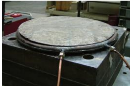
Figura 19 - Macaco plano utilizado no ensaio PR1 [2]
