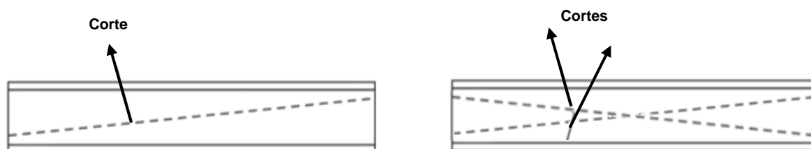
Figura 5.13 – Cortes a aplicar nos perfis IPE para obtenção dos reforços. Adaptado de [4].
