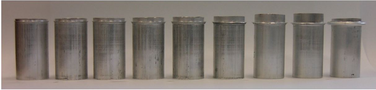
Figura 5.11: [Deformação plástica das pré-formas tubulares consoante a variação do espaçamento inicial entre matrizes l_{gap} . Valor crescente de l_{gap} da esquerda para a direita, com valor inicial de 5 e final de 16.
