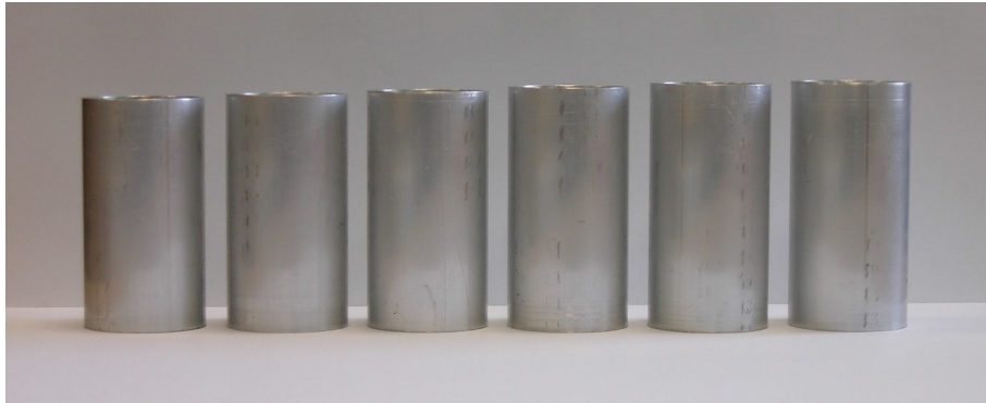
Figura 5.8: Pré-formas utilizadas nos ensaios de SBF. Valor crescente de l_0 da esquerda para a direita, com valor inicial de 60 e final de 65 mm.
