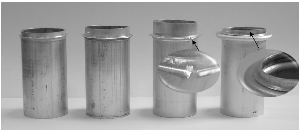
Figura 7.8: Modos de deformação para um conjunto de ensaios com uma espessura final de parede t=1.25 mm e um espaçamento inicial l_{gap} entre 5 e 16 mm (5,10,14,16 presentes na primeira coluna na Tabela 5.2).
