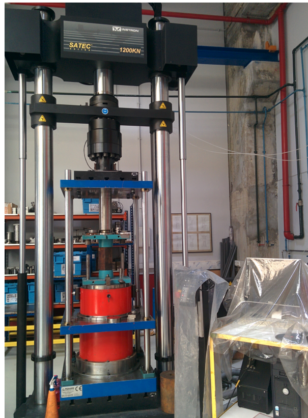
Figura 5.5: Máquina de ensaios INSTRON 1200 kN utilizada no procedimento experimental com aquisição de dados.
