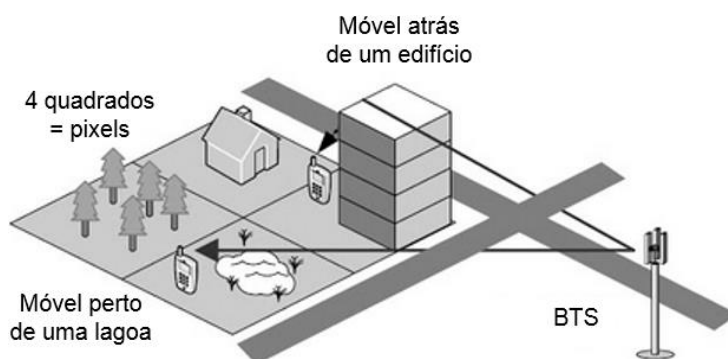
Figura 9 – Comunicação entre uma BTS e dois móveis, afectada pelo clutter local.
