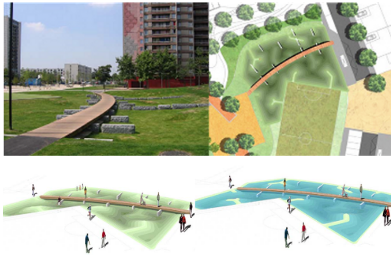
Figura 2.17 – Exemplo de uma solução possível de infiltração e retenção de água no espaço urbano em Paris. Adaptado de (EIVP, 2013)
