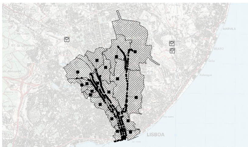
Figura 4.19 – Representação do modelo em SWMM do sistema de drenagem unitário das bacias hidrográficas da Av. Da Liberdade e da Av. Almirante Reis
