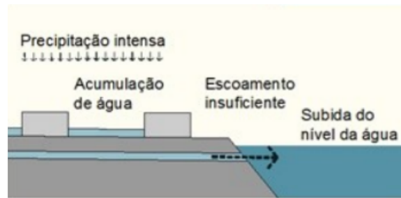
Figura 2.5 – Esquema ilustrativo da relação entre a subida do nível médio do mar, precipitação intensa e a drenagem urbana (Oliveira, 2013).
