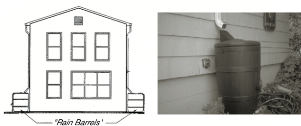
Figura 2.11 – Esquema e imagem exemplificativos da solução de controlo de origem “ Rain Barrels ”. Adaptado de (Prince George’s County - Department of Environmental Resources, 1999).
