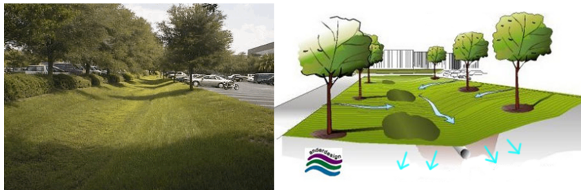
Figura 2.16 – Imagem e esquema ilustrativo do funcionamento de valas revestidas com coberto vegetal (Adaptadas de (Chesapeake Stormwater Network, 2014); (Prince George’s County - Department of Environmental Resources, 1999).
