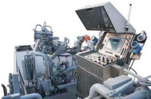
Figura 2.14: Doseador automático para o fabrico de calda de cimento na técnica de JG (adaptada de http://www.brighteroil.com/eng/channel.php?channel=cementing-equipment – 19:37h, dia 15/12/2014).
