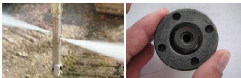
Figura 2.18: Detalhe de bicos de injeção para a realização da técnica de JG (adaptada de Tinoco, J. A. B. (2012)).
