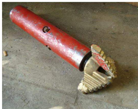
Figura 2.19: Segmento de vara de furação, com bicos de injeção incorporados e bit na sua extremidade (adaptada de Tinoco, J. A. B. (2012)).
