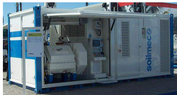
Figura 2.15: Bombas e compressores necessários à técnica de JG (adaptada de http://www.soilmec.com/en/viewdoc.asp?co_id=3276 – 19:41h, dia 15/12/2014).
