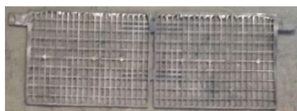
Fig. 3.7 – Exemplo duma armadura de painel duplo.
