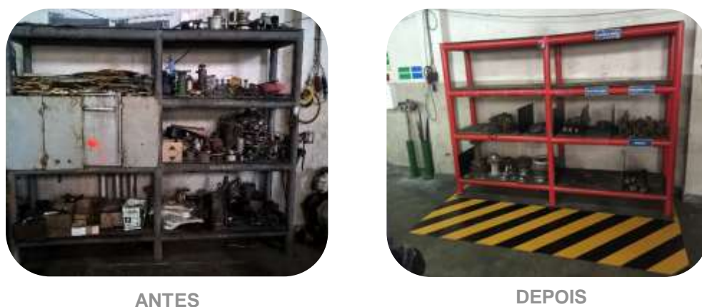
Figura 19. Antes e depois dos 5'S à estante de peças da oficina mecânica.
