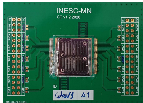
(d) Result – PCB, MR sensors and microfluidic channels.
