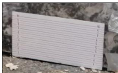
Figura 4.7 - Utensílio utilizado para medição da altura de escoamento
