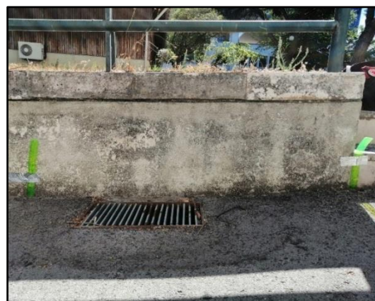
Figura 4.4 - Colocação das réguas a montante e jusante para a campanha relativa ao sumidouro 2 de Civil
