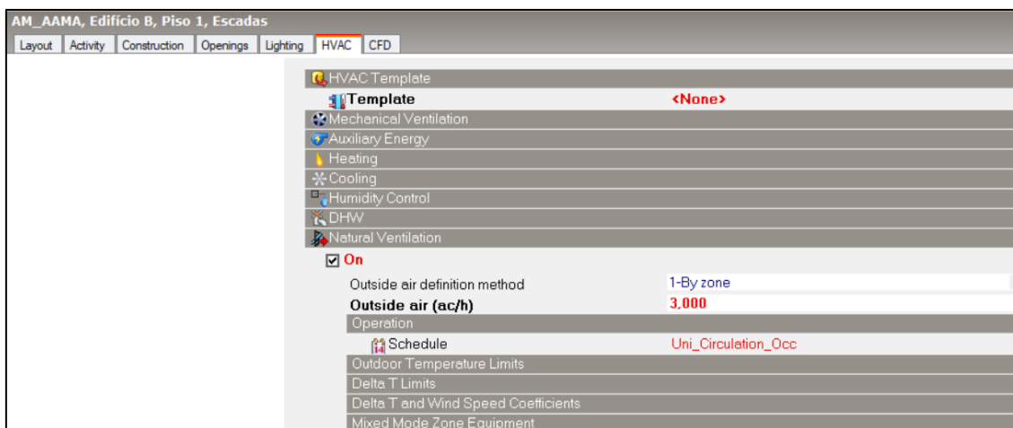
Figura 36: Caracterização do sistema de ventilação natural nas escadas
