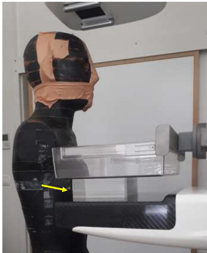
Figura 16- Placas de PMMA colocadas no mamógrafo.
