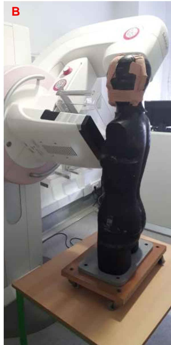
Figura 19 A e 19 B- Posicionamento do detetor de raios X para a aquisição da projeção médio oblíqua lateral do 2º e 3º conjuntos do 2º plano de irradiações.
