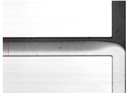
(b) Escoamento no canal sem obstáculos com identificação (tracejado vermelho) da secção de medida de \alpha_{mix} (ampliação \times 10 )
