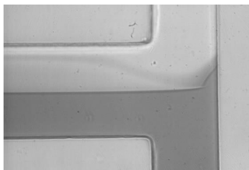
Figura 54: Junção T do micromisturador sem obstáculos para Q_{in1}=310 \mu\text{l}/\text{min} e Q_{in2}=330 \mu\text{l}/\text{min} (ampliação \times 40 ).
