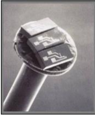
(a) Três sensores de pressão arterial na cabeça de um pino
