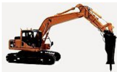
Figura 6: Retroescavadora com martelo demolidor (Gerador de Preços, 2019).
