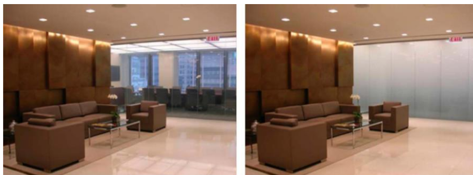
Figura 9- Modos de funcionamento PDLC: modo transparente e modo opaco respetivamente
