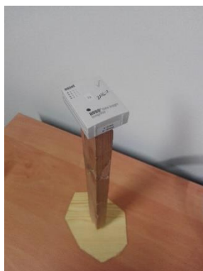
Figura 32- Sensor Hobo U12-011 Temp/RH colocado à altura do hipotálamo
