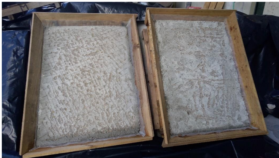
Figura 3.8 - Painéis preparados para receber o betão projetado
