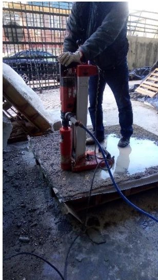
Figura 3.14 - Extração de carotes com caroteadora
