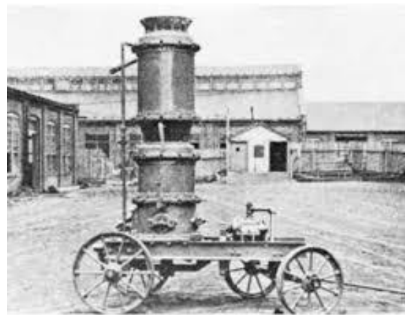
Figura 2.2 - Plastergun utilizada em 1907 por Carl Akeley (Teichert, 2002)
