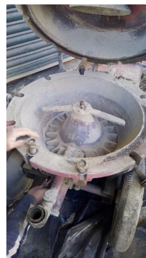
Figura 3.11 - Interior da câmara inferior da máquina de projeção
