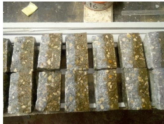
Figura 3.21 - Provetes de betão depois de aplicada a solução de nitrato de prata
