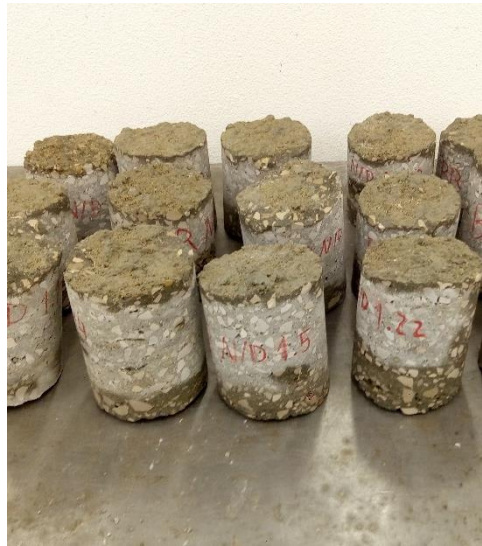
Figura 3.15 - Carotes após extração
