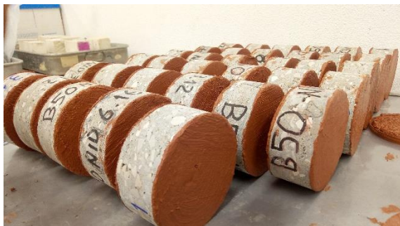
Figura 3.22 - Provetes depois de aplicada a impermeabilização dos topos
