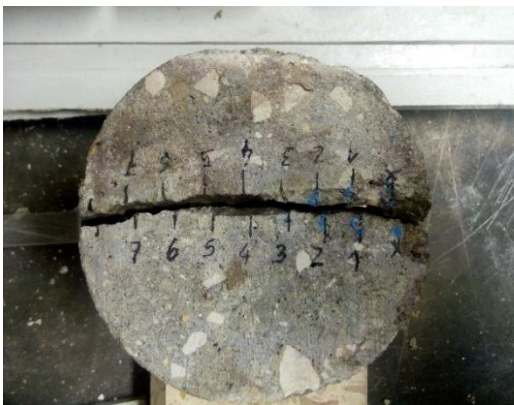
Figura 3.20 - Marcações para a medição da penetração dos cloretos
