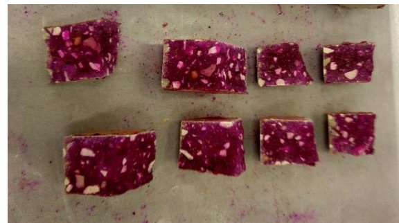
Figura 3.23 - Provetes depois de aplicada a fenolftaleína
