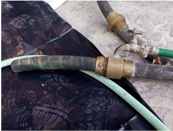
Figura 3.12 - Ponta da mangueira de projeção
