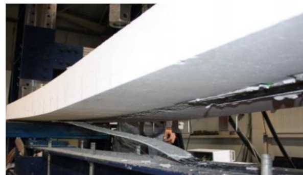
Figura 3.6. Reforço de viga com laminados, ocorrendo descolamento prematuro, [3]
