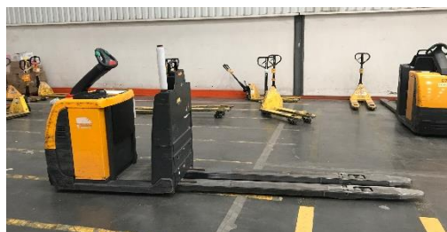
Figura 29 - Mota de picking , com capacidade para duas paletes, utilizada no picking to order .
