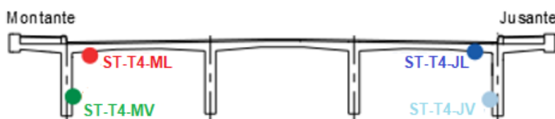
Figura 4.9: Posição dos sensores no tabuleiro, tramo T4
