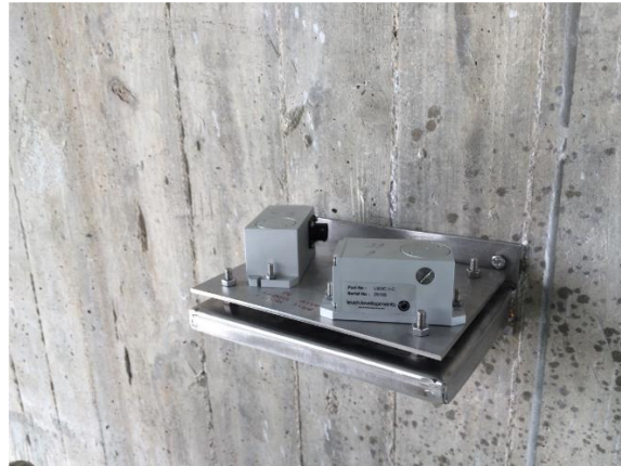
Figura 3.7: Inclinómetro uniaxial do tipo LSOC-1-C
