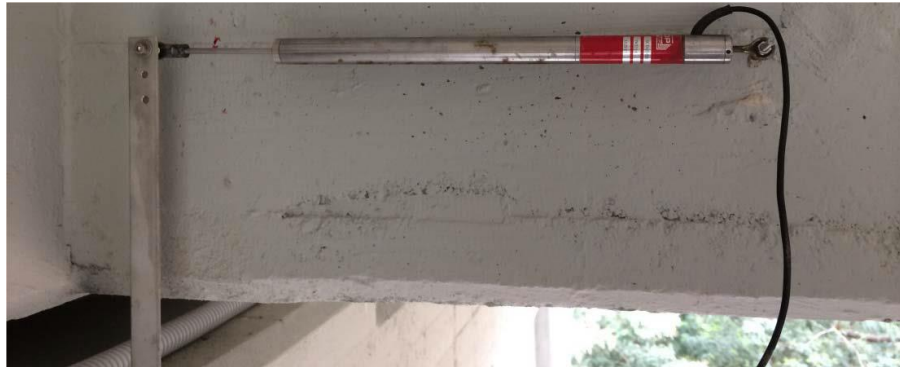
Figura 3.9: LVDT do tipo DCRH2000C/371
