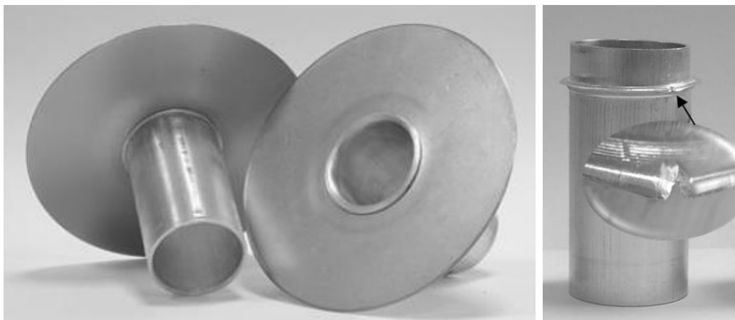
Figura 6- Ligação resultante do processo anterior (Alves et al., 2017). a) Saliência formada na superfície da chapa pela dobragem do tubo. b) Fissura resultante do limite crítico de expansão tangencial para o material em estudo.
