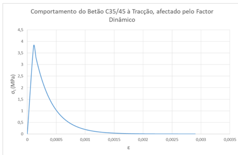
Figura 3.7 - Relações constitutivas do betão à tracção, afectadas pelo factor dinâmico
