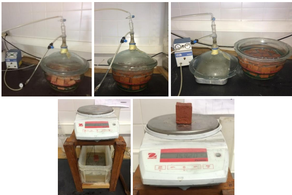
Figura 3.8 - Etapas do processo de determinação de porosidade acessível à água em provetes prismáticos.
