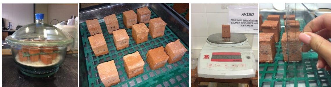
Figura 3.6 - Etapas do ensaio de absorção de água por capilaridade em provetes prismáticos.
