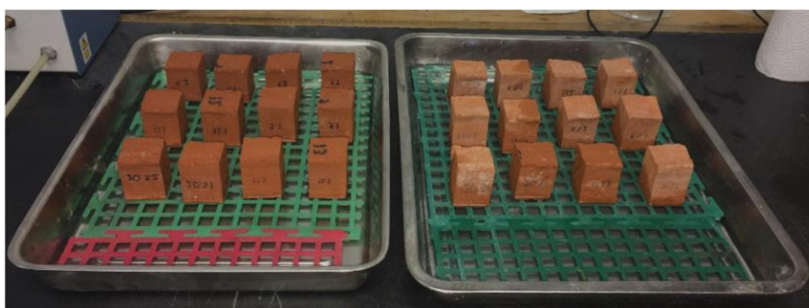
Figura 5.14 - Ensaio de absorção de água por capilaridade - provetes não tratados e tratados.
