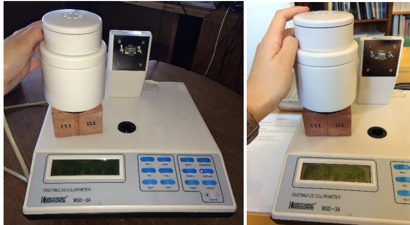
Figura 3.14 - Caracterização colorimétrica de provetes antes e após tratamento consolidante.
