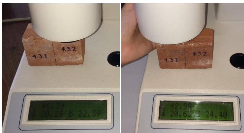
Figura 5.21 – Provetes antes e após tratamento consolidante – ensaio de caracterização colorimétrica.
