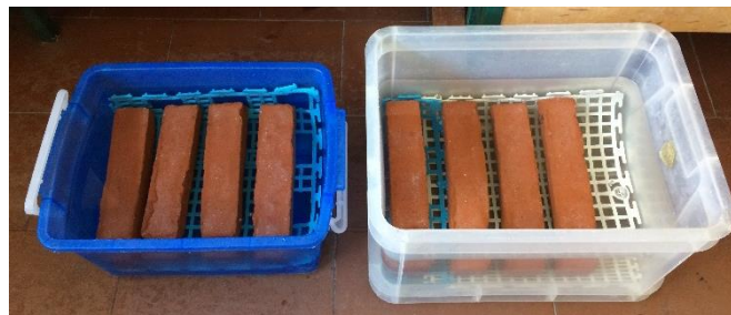
Figura 3.9 - Submersão de tijolos inteiros em água por 48h.
