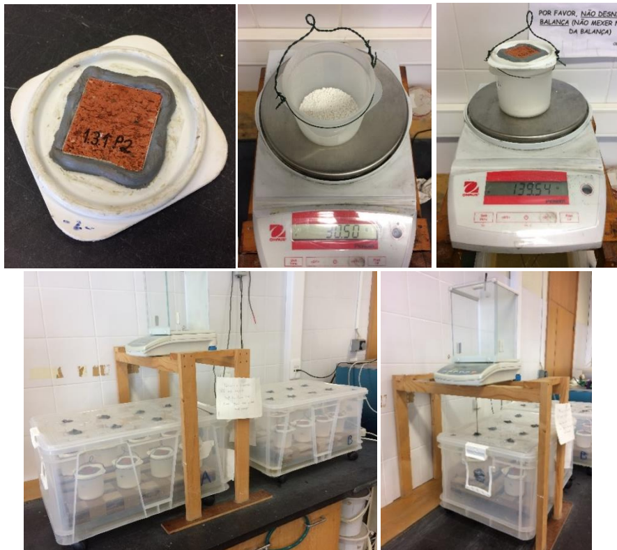
Figura 3.11 - Etapas do ensaio de permeabilidade ao vapor de água.
