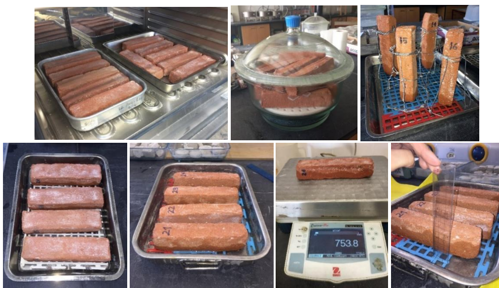
Figura 3.5 - Etapas do ensaio de absorção de água por capilaridade em tijolos inteiros.
