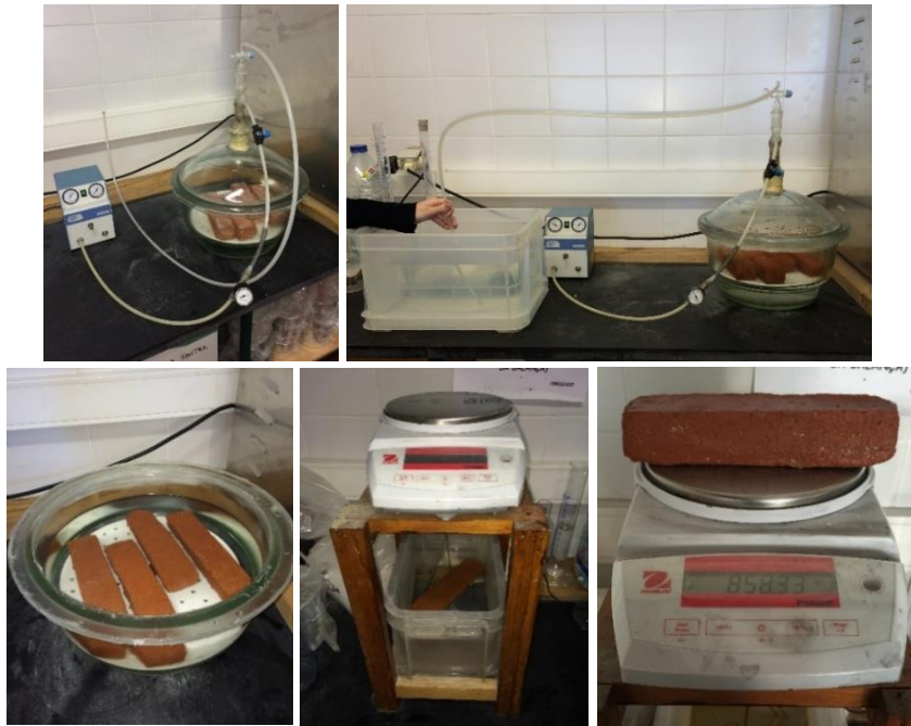
Figura 3.7 - Etapas do procedimento de determinação de porosidade acessível à água em tijolos inteiros.
