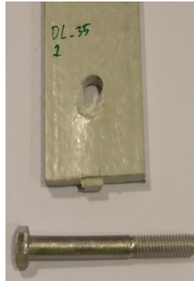
Figura 52 - Modo de rotura por shear-out com esmagamento do provete 1 da série DL-35.
