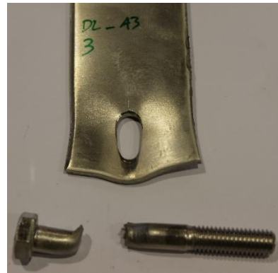
Figura 64 - Modo de ruptura por flexão e corte do parafuso de um provete da série DL-A3. (2)
