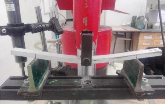
Figura 30 - Rotura das primeiras fibras por tracção num provete.
