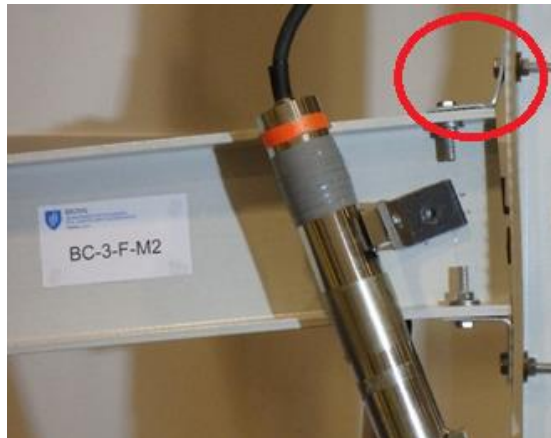
Figura 83 - Deformação plástica da cantoneira superior no provete 2 da série BC-3-F-M.
