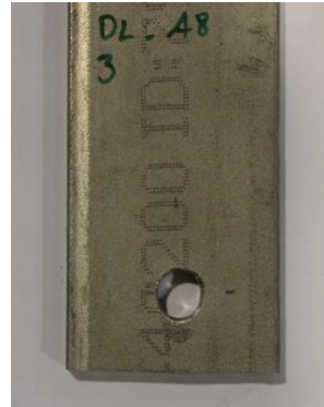
Figura 69 - Modo de rotura de um provete da série DL-A8. (2)
