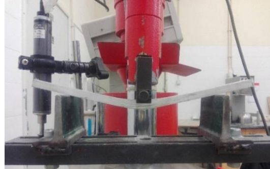
Figura 31 - Progressão da rotura de um provete ao longo da espessura.
