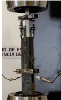
Figura 46 - Esquema dos ensaios de sobreposição dupla (2).
