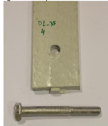
Figura 54 - Modo de rotura por shear-out dos provetes 2 e 4 da série DL-35.
