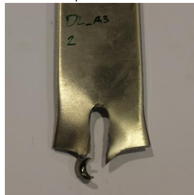
Figura 66 - Modo de ruptura por esmagamento da chapa de aço de um provete da série DL-A3. (2)
