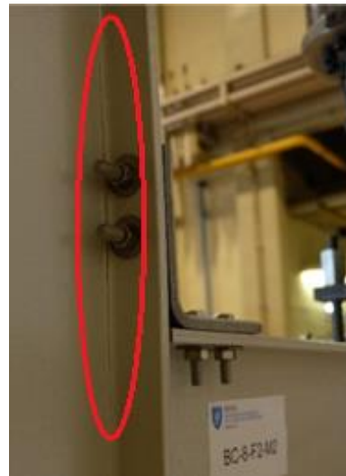
Figura 89 - Modo de rotura de um provete da série BC-8-F2-M pela ligação banzo-alma da coluna.
