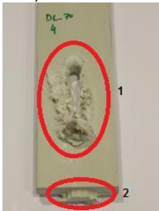
Figura 57 - Modo de rotura por esmagamento (1) e por shear-out (2) de um provete da série DL-70 (2).
