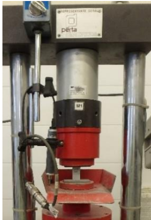
Figura 20 – Esquema do ensaio de compressão, com o ensaio em curso.
