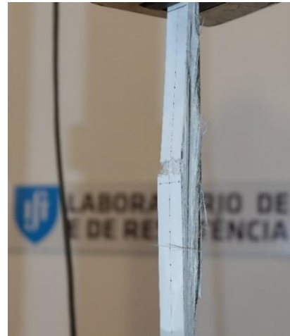
Figura 27 - Modo de rotura do ensaio de tracção do GFRP, por tracção das fibras.
