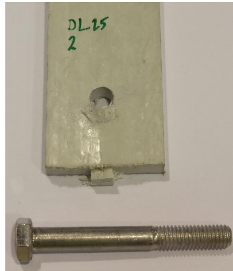
Figura 50 - Modo de rotura por shear-out de um provete da série DL-25.
