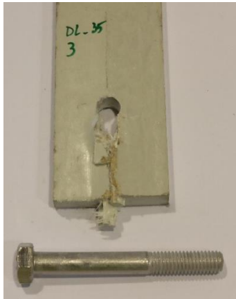
Figura 53 - Modo de rotura por shear-out com duas superfícies de rotura do provete 3 da série DL-35.
