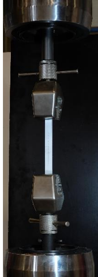
Figura 24 – Esquema do ensaio de tracção do GFRP, com o ensaio em curso.
