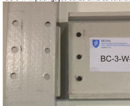
Figura 80 – Furos da coluna e da viga não danificados num provete da série BC-3-W-M.
