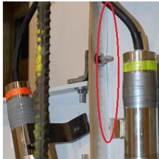
Figura 85 - Modo de rotura de um provete da série BC-8-F-M pela ligação banzo-alma da coluna (1).
