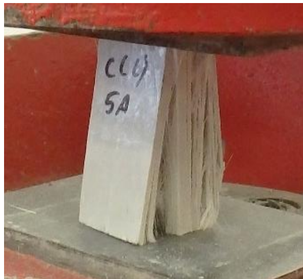
Figura 23 - Modo de rotura do ensaio de compressão, por delaminação do material.
