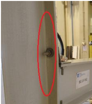
Figura 82 - Modo de rotura do provete 2 da série BC-3-F-M pela ligação banzo-alma da coluna.
