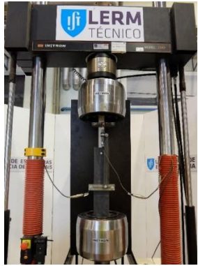
Figura 45 - Esquema dos ensaios de sobreposição dupla (1).
