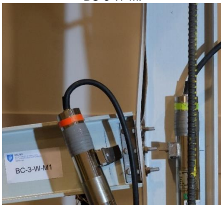
Figura 79 - Arrancamento das mantas de um provete da série BC-3-W-M.
