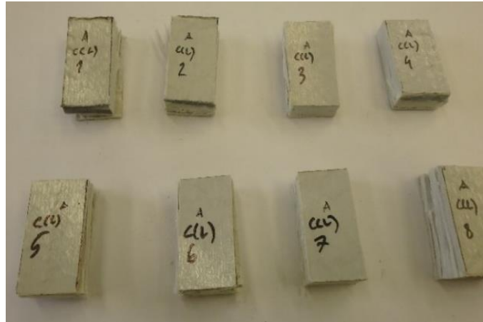
Figura 21 - Série de provetes longitudinais da alma após o ensaio de compressão.
