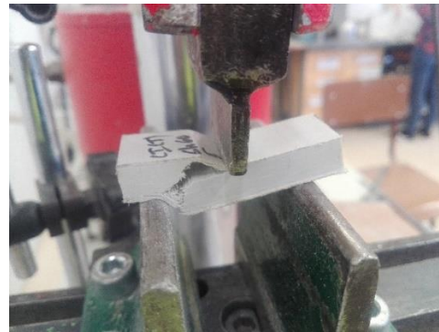
Figura 35 - Modo de rotura no ensaio de corte interlaminar na direção transversal, por corte.
