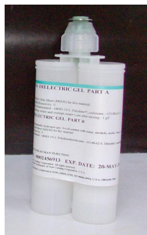
Figura 1.6 – Gel dielétrico usado no encapsulamento do material IPMC [50].
