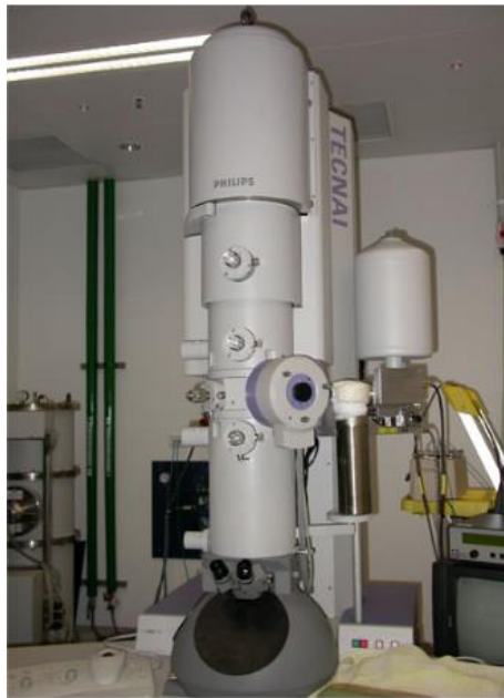
Figura 1-3 – Exemplo de um microscópio eletrónico de transmissão [40]
