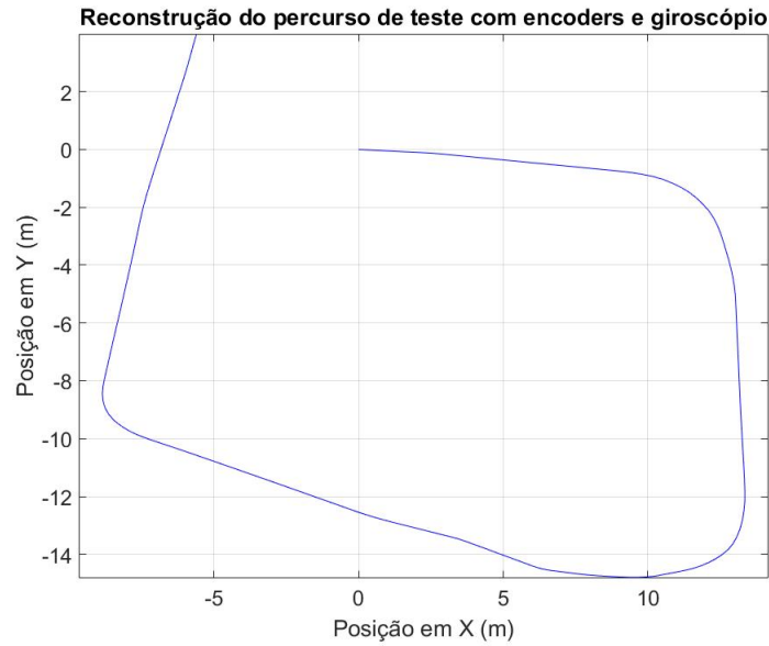
Figura 3.23: Reconstituição do percurso de teste com base nos dados dos encoders e giroscópio.
