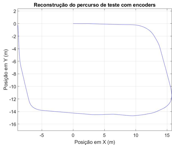
Figura 3.24: Reconstituição do percurso de teste com base nos dados dos encoders.
