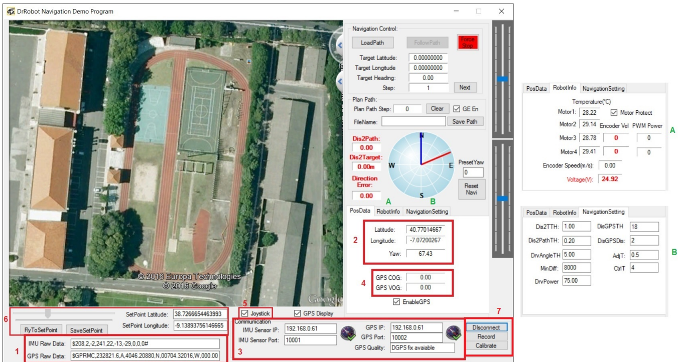
Figura 3.9: Aparência da aplicação quando conectada ao robot.
