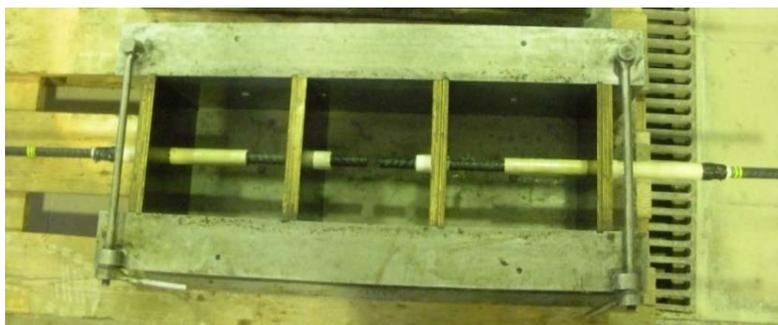
Figura 5.7 – Molde preparado para a betonagem de dois provetes
