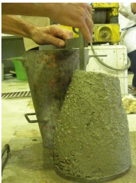
Figura 5.17 – Medição do abaixamento do cone de Abrams da 1ª amassadura da mistura C250
