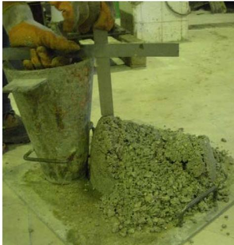
Figura 4.6 – Ilustração do abaixamento deformado do cone de Abram's
