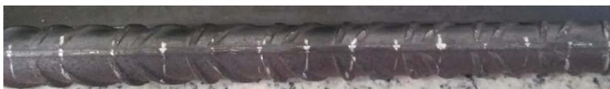
Figura 5.14 – Marcação da amostra com espaçamento de 10 mm
