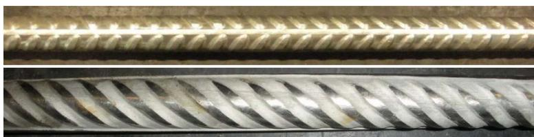
Figura 5.11 – Representação dos varões de aço inoxidável Ø12 (em cima) e Ø16 (em baixo)
