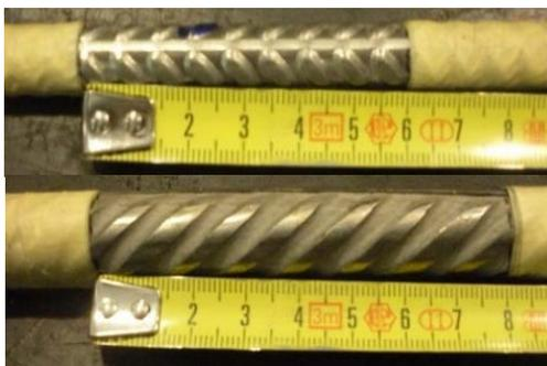
Figura 5.8 – Comprimento aderente Ø12 (em cima) e Ø16 (em baixo)
