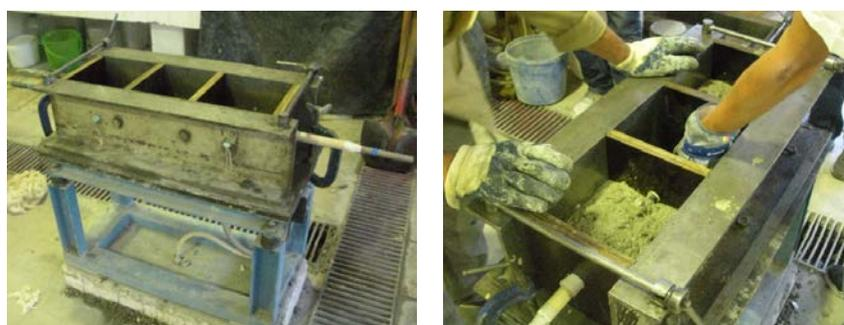
Figura 5.10 – Mesa vibratória usada para fornecer energia de compactação suficiente (à esquerda) e primeira etapa de enchimento dos moldes (à direita)
