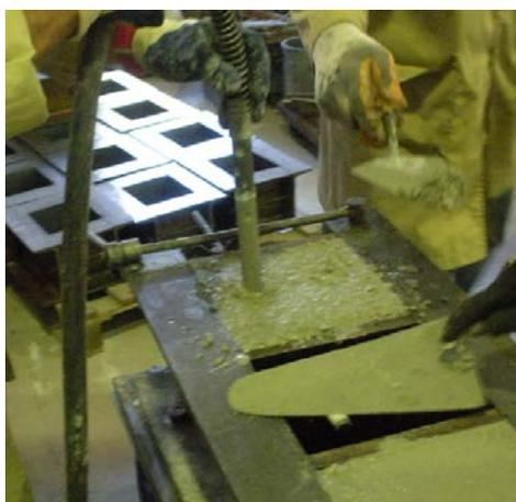
Figura 5.16 – Vibração do betão com recurso a mesa e agulha vibratória
