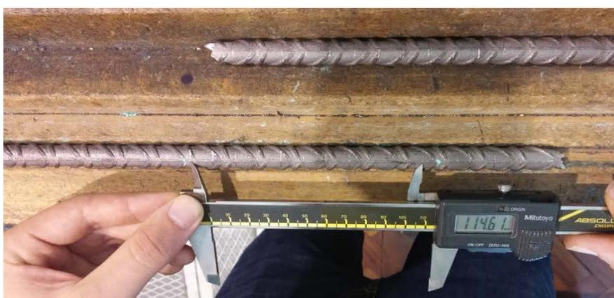
Figura 5.15 – Medição da extensão permanente na força máxima
