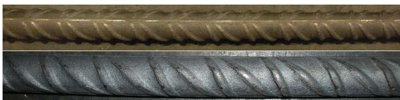
Figura 5.12 – Representação dos varões de aço A500 NR SD Ø12 (em cima) e Ø16 (em baixo)
