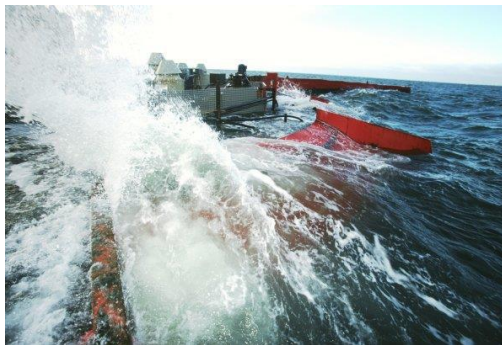
Figura 2.12 – Dispositivo de conversão de energia das ondas – Wave Dragon [22]
