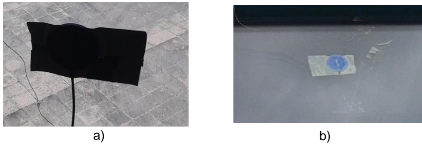
Figura 4.10 - Fluxímetro: a) vista interior; b) vista exterior.
