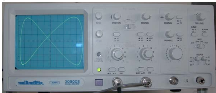
Figura 8: Imagens do gerador e dos osciloscópio utilizados no trabalho. O osciloscópio mostra uma figura de Lissajou em que os dois sinais eléctricos têm a mesma frequência.
