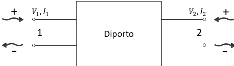
Figura 4.2: Convenção assumida de direção das ondas de scattering de um diporto, como o considerado nesta secção.
