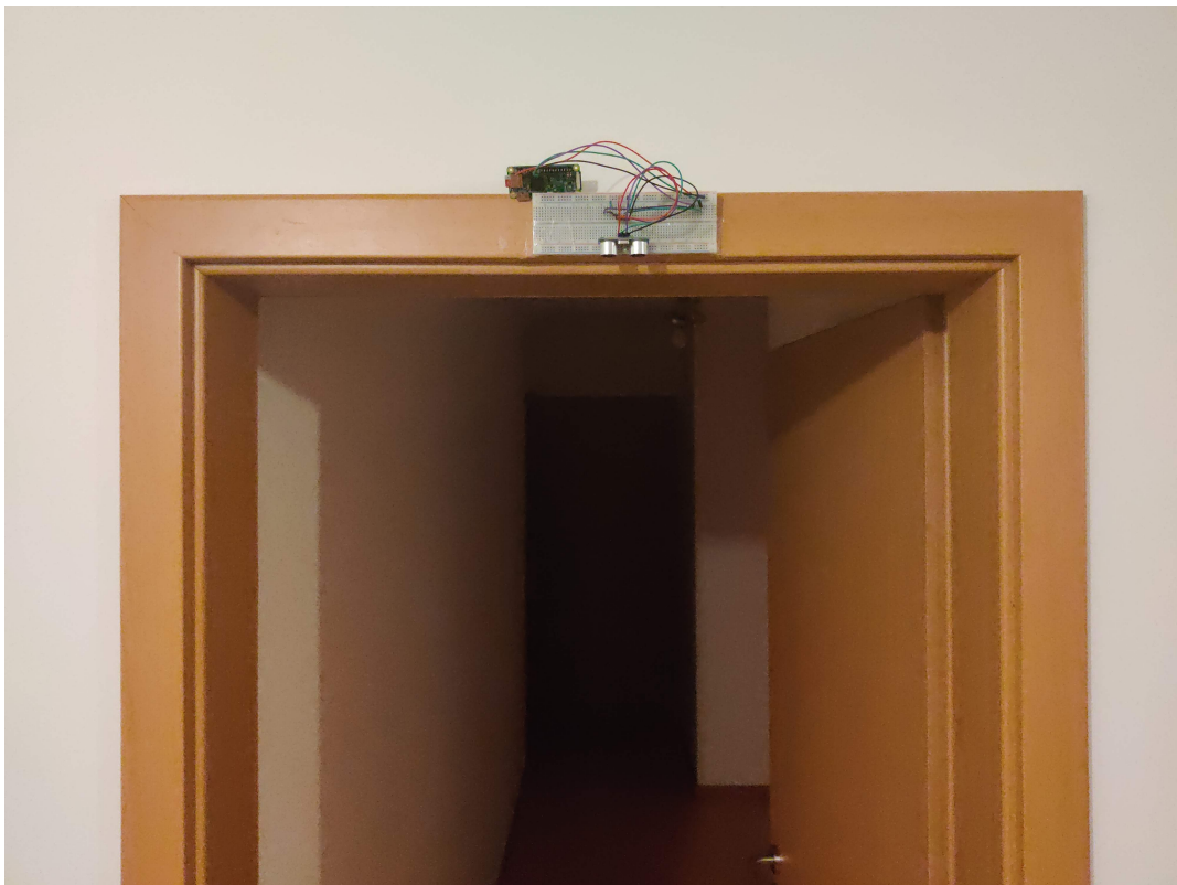
Figura 6.4: Montagem dos sensores de ultrassons sobre a porta.
