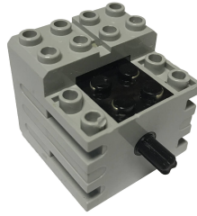
Figura 4.3: Motor LEGO® utilizado no robot.
