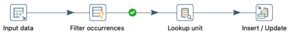
Figura D.14: Transformação para carregar os dados na dimensão Grupo de Unidades
