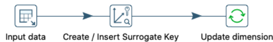
Figura D.41: Transformação para carregar as localizações das estações meteorológicas na dimensão Localização
