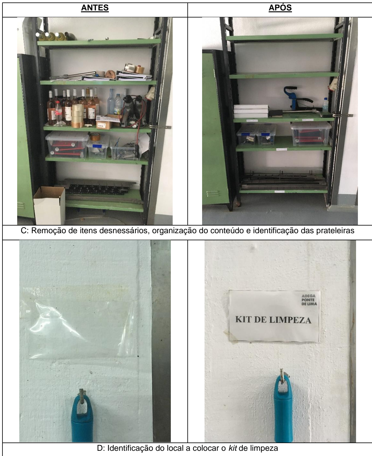
Figura 15 (continuação) – Antes e após a implementação da ferramenta 5S, na Zona 2
