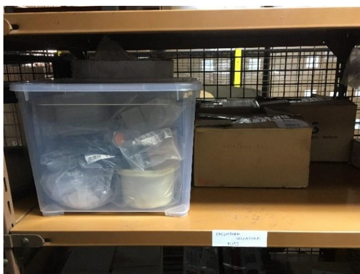
Figura 19 – Armazenamento de material solto dentro de recipiente transparente novo e identificação da prateleira em função do posto de trabalho/equipamento
