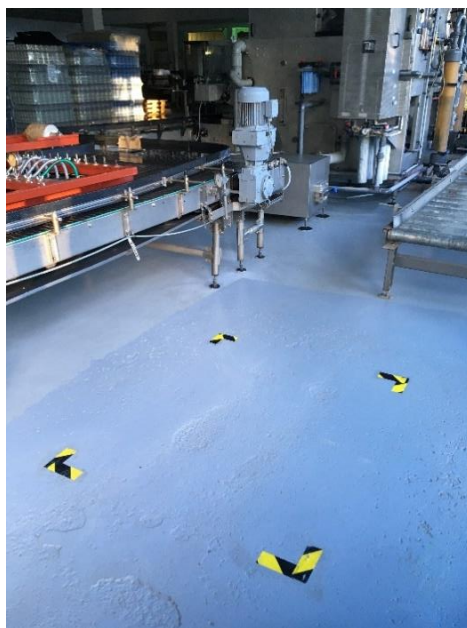
Figura 11 – Marcação do chão para colocação da palete no despaletizador
