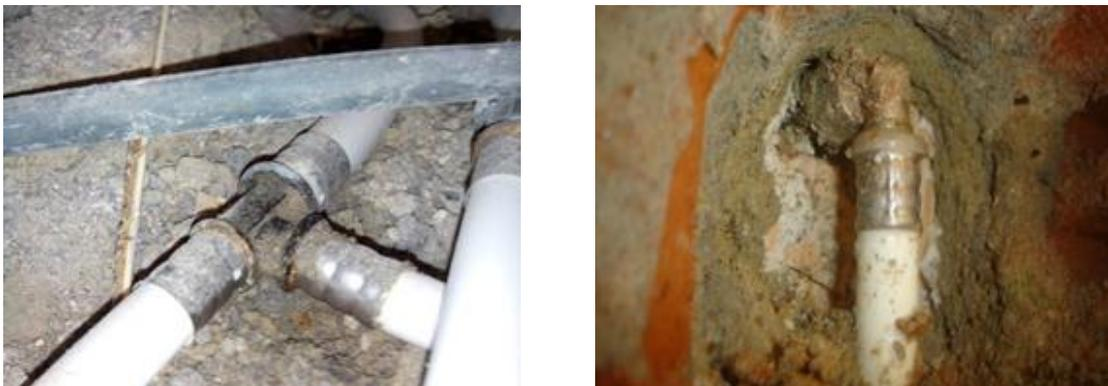
Figura 3.2 – Roturas em tubagens multicamada
