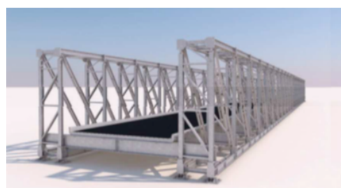
Figura 32 : Ponte MB60 (retirado de ( BERD , 2019))
