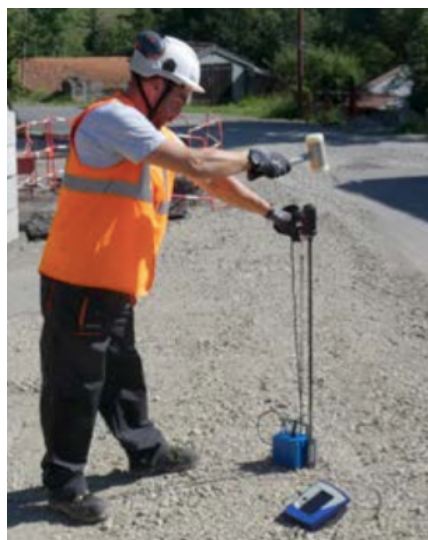
Figura 38 : Operação com o sistema PANDA (retirado de (Sol-Solution, 2020))
