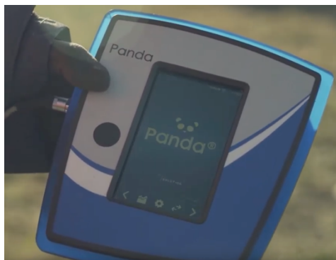
Figura 37 : Tablet do sistema PANDA (retirado de (Sol-Solution, 2020))
