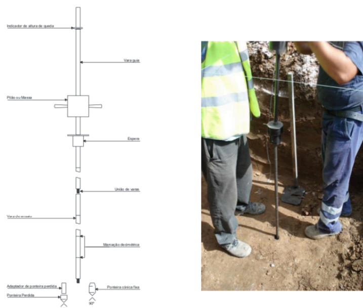
Figura 36 : Composição do PDL à esquerda e utilização em obra do PDL à direita (retirado de (Dias, 2013))
