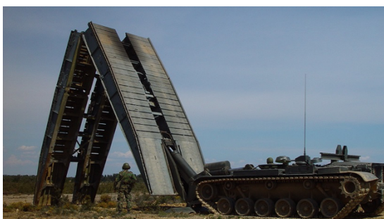
Figura 9 : Viatura Blindada Lança Ponte M60A1 (retirado de (DMT, 2016))
