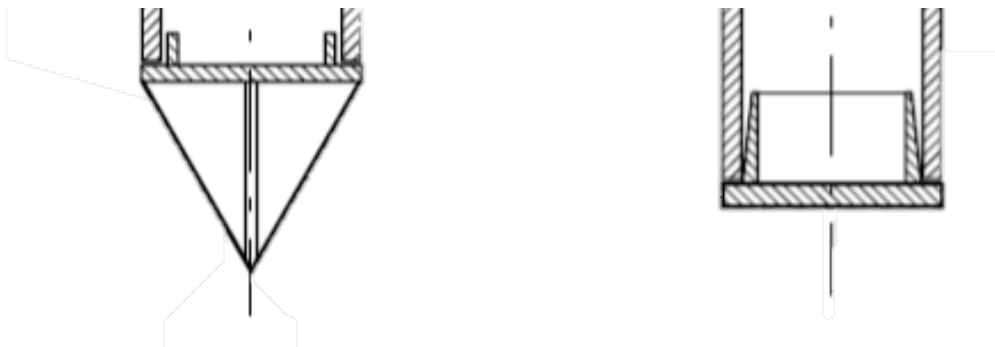
Figura 48 : Cortes longitudinais da sapata de ponteira de cravação à esquerda e da sapata de tampão de fundo à direita (retirado de (Caetano, 2014))
