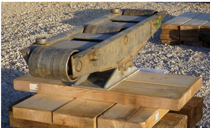
Figura 13 : Apoios provisórios (Rollers) (retirado de (Companhia de Pontes, 2015))
