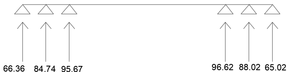
Figura 40 - Reações nos apoios no modelo de análise, em kN, para a ação do peso próprio (corte transversal do apoio de extremidade)
