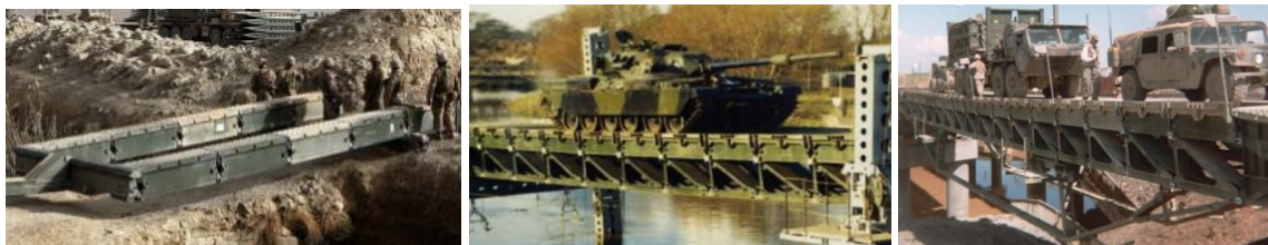
Figura 7 – Ponte MGB com módulo simples, duplo e duplo com reforço (da esquerda para a direita). Adaptado de Thinkdefense (2012)
