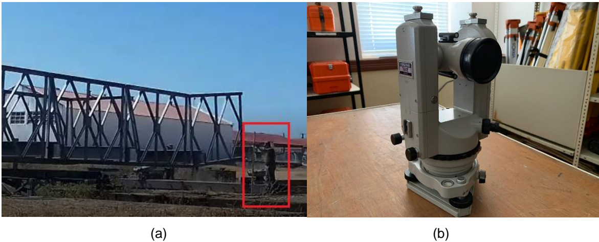
Figura 61 – a) Colocação da Régua de Mira na posição final da consola; b) Teodolito Sokkisha T60E utilizado. Fotografias tiradas em Tancos dia 10/07/2020
